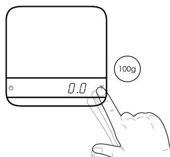
3 Continuez d'appuyer sur le bouton 'T' jusqu'à ce que 'CAL' apparaisse sur l'affichage.
