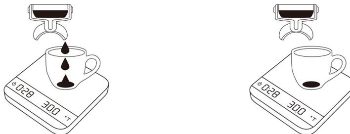
2. Dans tous les modes de démarrage automatique, si la balance n'est pas utilisée pendant 30 secondes, elle réinitialise le minuteur et calcule la tare.
