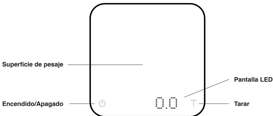
\* Nota: para un óptimo rendimiento, coloque el peso en el centro de la superficie de pesaje.
