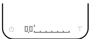
Un modo de medición de la velocidad de caudal en tiempo real para poner en práctica la estabilidad de su vertido. La velocidad de caudal actual se muestra a la izquierda y la estabilidad del vertido, mediante la barra indicadora.
