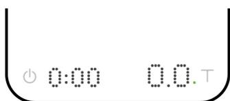
El modo Espresso se ha diseñado para facilitar la preparación del espresso. La balanza detecta automáticamente la presencia de una taza, vaso corto u otro recipiente y determina su tara. A continuación, la balanza detectará el inicio del caudal de espresso
