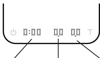
Este modo permite controlar el vertido durante la preparación del café. La pantalla muestra el temporizador, la velocidad de caudal y el peso.
