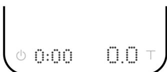
En el modo Pantalla doble, la balanza muestra [ 0:00 0.0 ] (el temporizador a la izquierda y el peso a la derecha).
