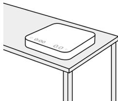
Coloque la balanza en una superficie de trabajo estable, uniforme y sin vibraciones.
