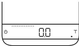
In diesem Modus führt die Waage nur eine automatische Tarierung durch. Sobald Sie die Tasse auf die Waage stellen, führt sie eine automatische Tarierung durch. Lassen Sie den Espresso wie gewohnt einlaufen. Bei Entnahme der Tasse von der Waage wird eine Zusammenfassung vom Brühvorgang des Espressos angezeigt.
