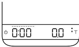
Dieser Modus wurde entwickelt, um das Aufbrühen von Pour-Over-Kaffee zu unterstützen. Die Waage erkennt den Beginn des Flusses aus dem Wasserkocher in das Gefäß und startet automatisch den Timer. Der Timer stoppt, wenn das Brühgerät von der Waage entfernt wird. Nach Entfernen des Geräts blinkt die Anzeige mit dem endgültigen Getränkegewicht auf.
