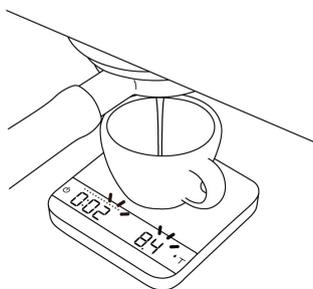
**3** Der Timer startet, wenn der Durchfluss von Espresso erkannt wird.
