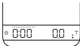
Dieser Modus ist für Baristi vorgesehen, die die gesamte Einlaufzeit messen möchten, einschließlich der Zeit vor dem Aufguss. Wird eine Tasse auf die Waage gestellt und hat sich der Anzeigewert ihres Gewichts eingependelt, führt die Waage eine automatische Tarierung durch und startet den Timer.
