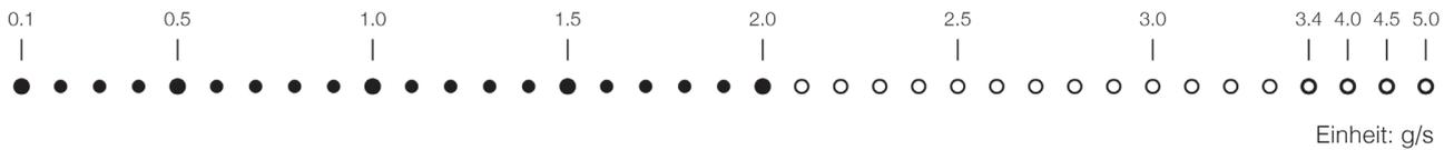
Der Durchflussanzeiger ist eine LED-Leiste oben auf dem Display. Er hilft Ihnen, Ihren Espresso-Durchfluss in Echtzeit zu visualisieren und während des Brühvorgangs Kanalisierungen zu erkennen.
