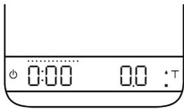
Dieser Modus ist für Baristi vorgesehen, die die Einlaufzeit ab den ersten wenigen Espressotropfen messen möchten. Sobald sich der Anzeigewert des Gewichts eingependelt hat, führt die Waage eine automatische Tarierung durch. Nachdem die Waage den Durchfluss von Espresso erkannt hat, startet der Timer automatisch. Sobald kein Espresso mehr durchfließt, stoppt der Timer automatisch.
