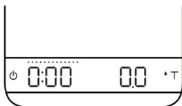
Sobald die Waage den Durchfluss von Espresso erkennt, startet der Timer. Sobald kein Espresso mehr durchfließt, stoppt der Timer.
