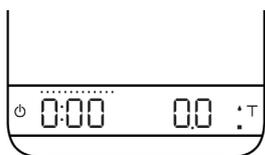
這個模式乃專為想測量每份濃縮咖啡沖煮時間的咖啡師所設計，可以從咖啡液滴落時開始計時。當重量讀數穩定時，咖啡秤會執行自動扣重作業。等到咖啡秤偵測到流下的濃縮咖啡液之後，計時器便會自動開始計時。當濃縮咖啡液不再流下時，計時器會自動停止計時。
