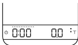
手沖自動計時模式是專為輔助手沖咖啡所設計的模式。咖啡秤能在您開始沖煮時偵測從細口壺流到玻璃壺的水流，同時自動啟動計時器功能。當您將沖煮器具自咖啡秤上拿起時，計時器即會停止。只要將容器從咖啡秤上拿起，最終的飲品重量就會在顯示畫面中閃爍顯示。
