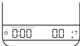
Este modo está diseñado para baristas que deseen medir el tiempo de una tirada de espresso a partir de las primeras gotas. Cuando la lectura del peso es estable, la balanza calcula la tara automáticamente. Cuando la balanza detecta el caudal de espresso, se inicia automáticamente el temporizador. El temporizador se detiene automáticamente cuando se interrumpe el caudal.
