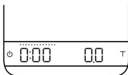
En el modo Pantalla doble, la balanza muestra [ 0:00 0.0 ] (el temporizador a la izquierda y el peso a la derecha).
