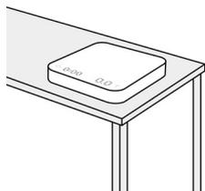
Achten Sie bei der Wahl einer Aufstellfläche für die Waage darauf, dass sie stabil, vibrationsfrei und eben ist.
