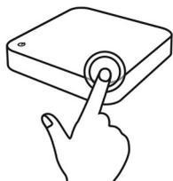
Tippen Sie die Tariertaste an, um das Gewicht zu tarieren / auf Null zu setzen.
