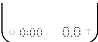
Im Doppelanzeige-Modus sehen Sie [ 0:00 0.0 ] auf der Waagenanzeige mit dem Timer (links) und dem Gewicht (rechts).
