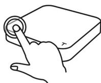
Tippen Sie die Power-Taste an, um die Waage einzuschalten. Tippen Sie zweimal auf die Power-Taste, um die Waage auszuschalten.
