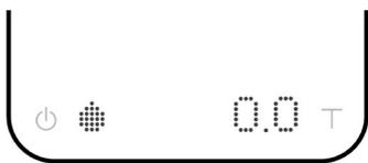
Dieser Modus ist als Hilfestellung bei der Espresso-Extraktion vorgesehen. Die Waage tariert automatisch das Gewicht des Behälters. Sie erkennt, wenn Espresso in den Behälter fließt, und startet dann automatisch die Timer-Funktion; der Timer stoppt, sobald kein Espresso mehr in den Behälter fließt.
