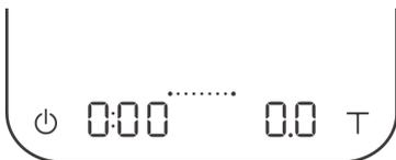
Im Doppelanzeige-Modus sehen Sie [ 0:00 0.0 ] auf der Waagenanzeige mit dem Timer (links) und dem Gewicht (rechts).
