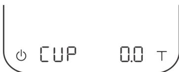
Dieser Modus misst das Verhältnis von Kaffee zu Getränk. Dies ist eine der einheitlichsten Methoden zum Messen von Pour Over-Aufgüssen. Am Ende des Brühvorgangs sehen Sie die Zeit des Brühvorgangs, die Gesamtmenge an hinzugefügtem Wasser, das Gewicht des Getränks im Behälter und das Verhältnis von Kaffee zu Getränk.
