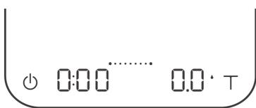
Der Pour Over-Auto-Start-Timer-Modus dient als Hilfestellung beim Aufbrühen von Pour Over Coffee. Die Waage erkennt den Abfluss aus dem Wasserkessel in den Behälter und startet automatisch den Timer. Der Timer stoppt, sobald die Brühvorrichtung von der Waage genommen wird. Bei der Entnahme des
