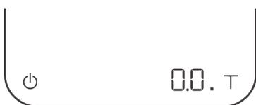
Der Siebträger-Modus dient zur Vereinfachung des Arbeitsgangs beim Abwiegen von Kaffeemehl in einem Siebträger. Die Waage erkennt automatisch einen Siebträger oder einen anderen Behälter und tariert das Gewicht des Behälters. Nehmen Sie den Siebträger ab, geben Sie Kaffeemehl hinein und stellen Sie ihn wieder
