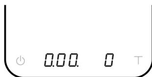
En el modo Pantalla doble, la balanza muestra [ 0.00. 0 ] (el temporizador a la izquierda y el peso a la derecha).
