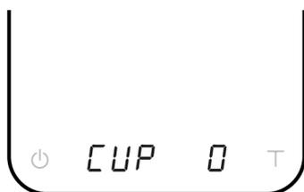
Diseñado para medidas de vertido y extracción, siga las instrucciones en la pantalla para colocar la jarra/taza, el filtro y el café (pulse el botón de tara entre los distintos pasos). El temporizador se iniciará cuando se detecte el primer caudal de agua. El temporizador se detendrá cuando se pulse el botón de encendido/apagado o se retiren los objetos (cono de goteo). El número intermitente es el peso de la bebida una vez retirados todos los objetos.
