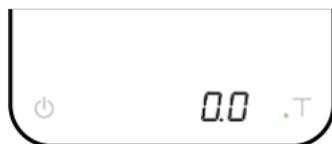
La balanza detecta automáticamente la presencia de un portafiltro o taza y calcula su tara. Retire el portafiltro para añadir el café molido y colóquelo de nuevo en la balanza para calcular el peso del café. Repita tantas veces como sea necesario para ajustar el peso. Tras retirar el portafiltro durante 15 segundos, la balanza se establecerá en el modo predeterminado para la siguiente operación.
