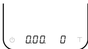
En mode Double affichage, la balance affiche [ 0.00. 0 ], avec le minuteur sur la gauche et le poids sur la droite.
