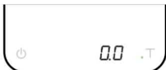
La balance détecte automatiquement un porte-filtre ou un autre récipient et calcule la tare. Retirez le porte-filtre, ajoutez du café moulu, et remplacez-le sur la balance pour mesurer le poids du café. Répétez si nécessaire pour ajuster le poids. Une fois le porte-filtre retiré, la balance passe au mode par défaut après 15 secondes.
