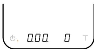
Placez un objet sur la balance. Appuyez sur la touche d'alimentation pour calculer automatiquement la tare et préparer le minuteur à détecter le débit d'eau. Le minuteur clignote, indiquant qu'il est prêt. Commencez à verser, et le minuteur démarre. Le minuteur s'arrête lorsque vous retirez le matériel d'infusion.
