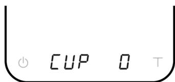
Conçu pour mesurer les débits et l'extraction. Suivez les instructions sur l'affichage pour placer la carafe/tasse, le filtre, et le café (appuyez sur la touche Tare entre les étapes). Le minuteur démarre lorsque le débit d'eau est détecté. Le minuteur s'arrête si vous appuyez sur la touche d'alimentation ou enlevez les objets (le goutteur). Le poids net du café (sans les autres objets) clignote sur l'affichage.
