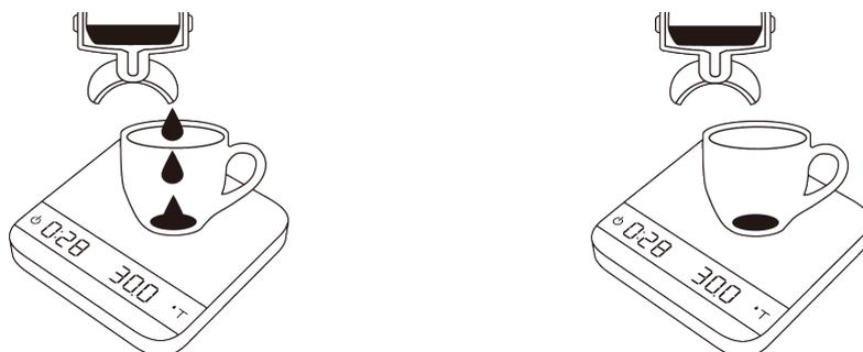
2. In tutte le modalità di avvio automatico, se non si utilizza la bilancia entro 30 secondi, il timer viene reimpostato e viene eseguita la tara.
