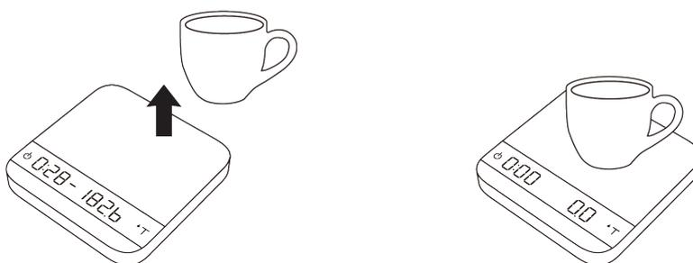
3. In tutte le modalità di avvio automatico, il timer si arresta quando viene rilevato un peso negativo (es. rimozione della tazza).
