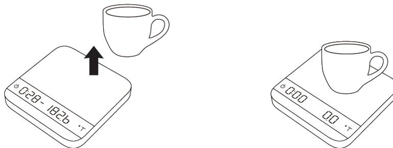
3. Der Timer stoppt in allen Automatisch starten-Modi, wenn ein negatives Gewicht (nämlich die Entnahme der Tasse) festgestellt wird.
