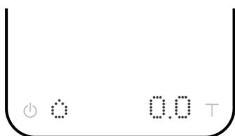
手沖自動計時模式是專為輔助手沖咖啡所設計的模式。咖啡秤能在您開始沖煮時偵測從細口壺流到玻璃壺的水流，同時自動啟動計時器功能。當您將沖煮器具自咖啡秤上拿起時，計時器即會停止。只要將容器從咖啡秤上拿起，最終的飲料重量就會在顯示畫面中閃爍顯示。
