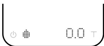
該模式是專為輔助濃縮咖啡萃取所設計的模式。咖啡秤會自動扣除容器的重量。當您開始萃取時，它能偵測流入容器的濃縮咖啡液，同時自動啟動計時器功能。當流入容器濃縮咖啡液停止時，計時器即會停止。
