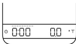
Cuando la balanza detecta el caudal de espresso, se inicia el temporizador. El temporizador se detiene cuando se interrumpe el caudal.
