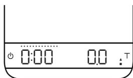
Este modo está diseñado para que los baristas midan el tiempo total de una tirada, incluido el tiempo de preinfusión. Una vez se haya colocado una taza en la balanza y se haya estabilizado la lectura del peso, la balanza efectúa la tara automática e inicia el temporizador.
