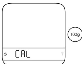
4 Coloque un peso de 100 g en la balanza y espere a que se muestre «\_End\_» en la pantalla. ¡Se ha completado la calibración!
