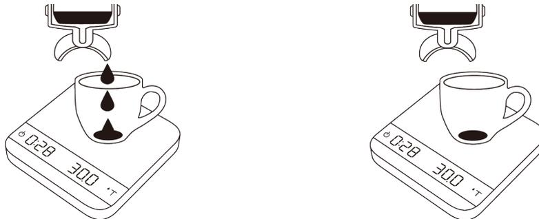
2. En todos los modos de inicio automático, si no se utiliza la balanza durante 30 segundos, se restablecerá el temporizador y se calculará la tara.
