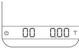
這個模式乃專為想測量每份濃縮咖啡沖煮時間的咖啡師所設計，可以從咖啡液滴落時開始計時。當咖啡秤偵測到穩定重量時，會執行自動扣重作業。等到咖啡秤偵測到流下的濃縮咖啡液之後，便會開始計時。當濃縮咖啡液停止流下時，計時器也會停止計時。
