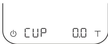
該模式能用來測量咖啡在飲品中的比例。這是測量手沖萃取最一致的方法之一。透過這個模式，您將能得知沖煮的經過時間、注水的總重量、玻璃壺內的飲品重量，以及在沖煮結束時咖啡在飲品中的比例。
