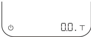
該模式的設計，能簡化測量沖煮把手內咖啡粉重量的工作流程。咖啡秤會自動偵測沖煮把手或其他容器，然後再扣除容器的重量。拿起沖煮把手並加入咖啡粉，再將把手放置於咖啡秤上測量咖啡粉的重量。視需要重複上一個步驟，調整咖啡粉的重量。移開沖煮把手15秒後，咖啡秤會將模式重設，以利您測量下一杯咖啡的咖啡粉。
