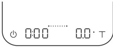
手沖自動計時模式是專為輔助手沖咖啡所設計的模式。咖啡秤能在您開始沖煮時偵測從細口壺流到玻璃壺的水流，同時自動啟動計時器功能。當您將沖煮器具自咖啡秤上拿起時，計時器即會停止。只要將容器從咖啡秤上拿起，最終的飲品重量就會在顯示畫面中閃爍顯示。
