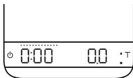
Ce mode est conçu pour les baristas qui veulent mesurer la durée du débit à partir des premières gouttes d'espresso. Lorsque la lecture du poids est stable, la balance calcule automatiquement la tare. Une fois que la balance détecte le débit d'espresso, le minuteur démarre automatiquement. Le minuteur s'arrête lorsque le débit d'espresso est interrompu.
