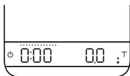
Ce mode est conçu pour les baristas qui veulent mesurer la durée totale d'un débit, y compris la durée de pré-infusion. Une fois qu'une tasse est placée sur la balance et que la lecture du poids est stable, la balance calcule automatiquement la tare automatique et lance le minuteur.
