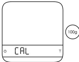
4 Stellen Sie ein Gewicht auf die Waage und warten Sie, bis »\_End\_« angezeigt wird. Die Kalibrierung ist jetzt abgeschlossen!
