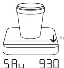
2 Tare-Taste 2 Sekunden lang gedrückt halten, sobald sich der Anzeigewert eingependelt hat. Das Gewicht wird dann als voreingestelltes Gewicht des Behälters abgespeichert.
