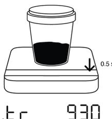
2 Tare-Taste 0,5 Sekunden lang gedrückt halten. Die Waage zeigt das abziehende Gewicht an.
