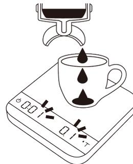
4 Der Timer startet, wenn der Durchfluss von Espresso erkannt wird.
