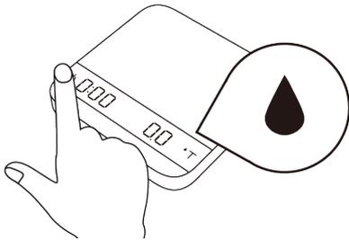
1 Das Tropfensymbol zeigt an, dass Sie sich im Modus Timerstart mit Durchfluss befinden.
