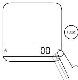
3 Continuez d'appuyer sur le bouton 'T' jusqu'à ce que 'CAL' apparaisse sur l'affichage.
