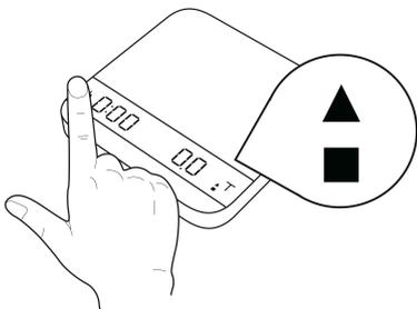
2 Une fois un poids stable, telle qu'une tasse, placé sur la balance, la tare est calculée automatiquement et le minuteur démarre.
